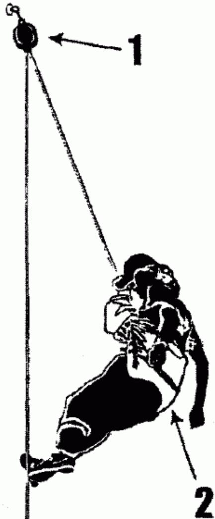
Система спасения и эвакуации, использующая индивидуальное спасательное устройство (ИСУ), предназначенное для спасения работника с высоты самостоятельно.
